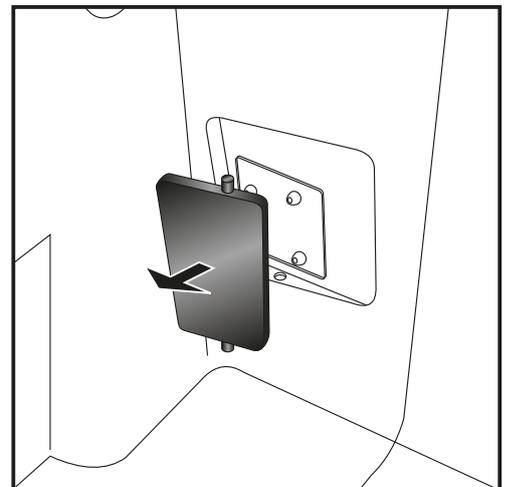
Zuerst die 4 Nieten ausbohren und entfernen mit denen das Kofferhalteschloss am Koffer befestigt ist. Bohrergröße: 4mm.
