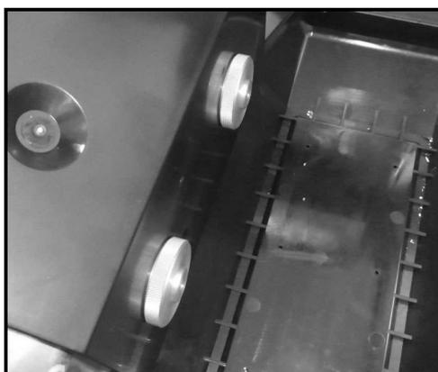
Die Rändelmuttern von innen auf die überstehenden Gewinde aufdrehen. Hinweis: Die Rändelmuttern mit der großen Auflagefläche gegen die Kunststoffinnenwand des Koffers schrauben, um die Druckbelastung gering zu halten und Spannungsrissen vorzubeugen!
